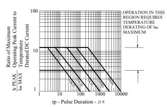
Fig.2 MAXIMUM TOLERABLE PEAK CURRENT VS. PULSE DURATION
