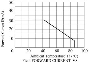
Fig.4 FORWARD CURRENT **DERATING CURVE**
