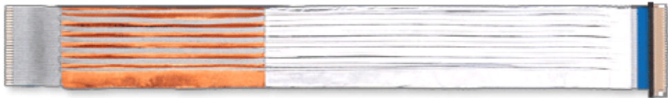
✦ 分 PIN 后中间垫铜箔外面包铝箔
